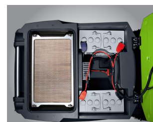
Duas baterias de 12V para até 4h de operação sem interrupções nem emissões
