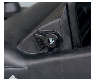
HKM 800: Ajuste da altura dos rolos simples e sem ferramentas
