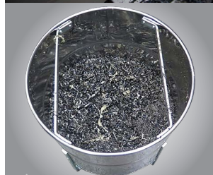
Depósito em aço inoxidável é resistente às aparas de metal afiadas
