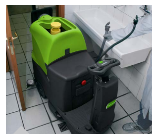
Depósito água limpa com mangueira para facilitar o enchimento do depósito
