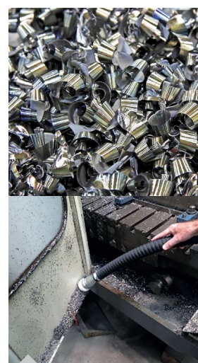
Depósito em aço inoxidável é resistente às aparas de metal afiadas
