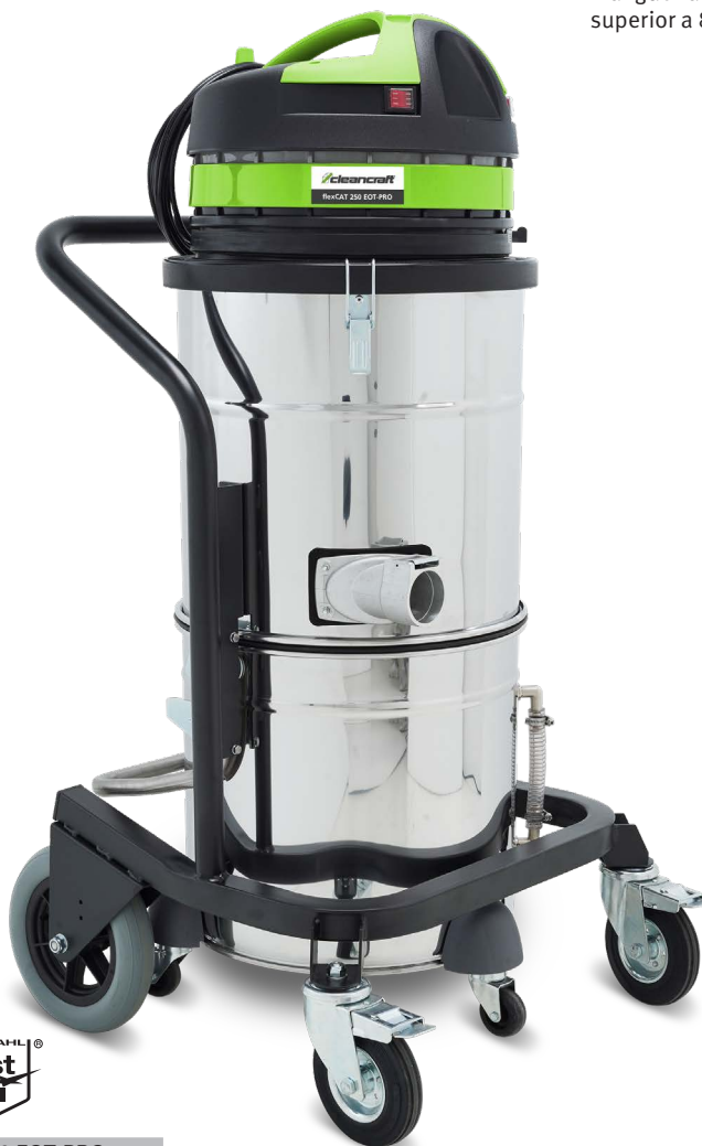
Sistema Flow-Mix patenteado : válvula pode ser usada para selecionar um caudal mais alto a uma pressão negativa constante ou uma pressão negativa mais alta com um caudal ligeiramente mais alto
