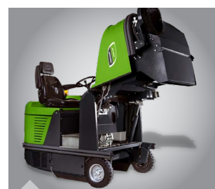
Esvaziamento do depósito hidráulico subindo até 1,5 m de altura
