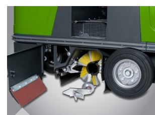
Escovas substituíveis sem necessidade de ferramentas
