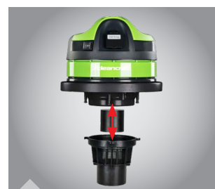
Sistema de flutuadores para desligar quando o reservatório está cheio de líquidos
