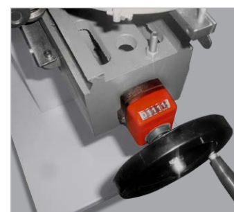
Ajuste conveniente e preciso da altura da mesa através de um volante com visor numérico
