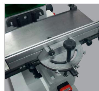
Guia angular ajustável em 60° para ambos os lados
