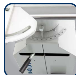
▶ Mesa ajustável em 60° para ambos os lados
