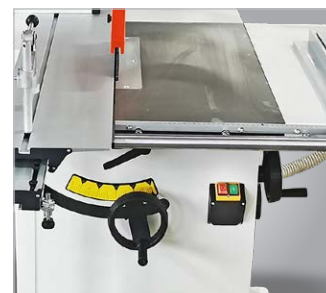
▶ Altura do disco e inclinação convenientemente ajustáveis através de volantes
