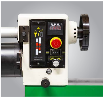
Display digital integrado para visualização da velocidade
