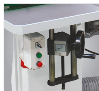
Mesa de lixar ajustável em altura utiliza toda a largura da correia de lixar
