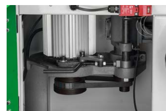
Mudança rápida e fácil de velocidades com múltiplas correias em V
