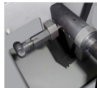
Perfuração em série através da unidade de cavilha com posições em grade 16/20/22/32 mm
