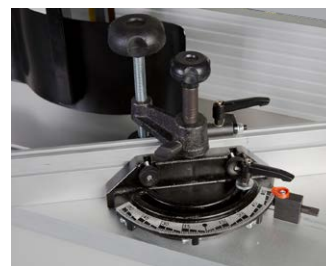
Batente de ângulo continuamente ajustável
