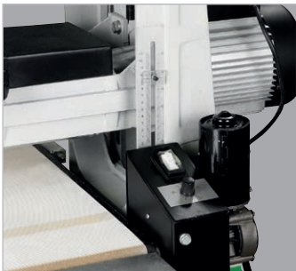
Ajuste da altura da unidade de lixa controlado pela escala
