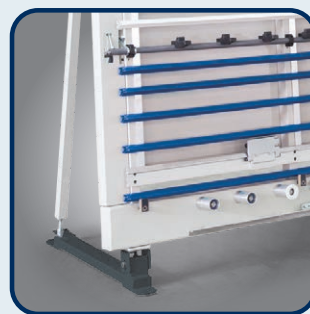
► Para impedir que a lâmina seja cortada num painel traseiro, a estrutura de ripas pode ser movida automaticamente
