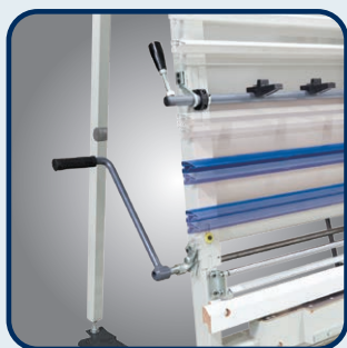
► Para impedir que a lâmina seja cortada num painel traseiro, a estrutura de ripas pode ser movida manualmente
