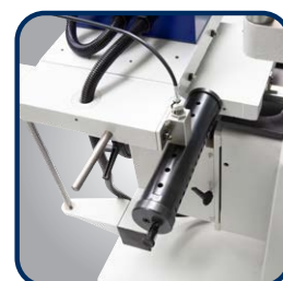
▶ Unidade de cavilha com posições grade 16 / 22 / 25 / 32
