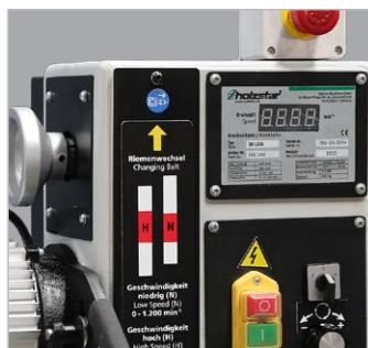
Regulação de velocidade variável em dois níveis
