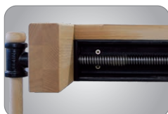
Guia linear sólida na mandíbula traseira
