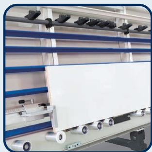
► Corte rápido e fácil, mesmo em peças pequenas. Suporte de placa inferior com escala
