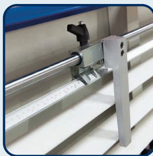
► Régua de ajustar comprimento de cortes verticais
