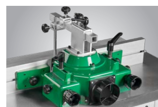
Batente de fresadora em alumínio ajustável
