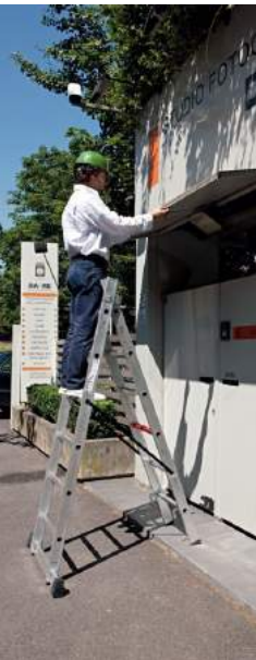
Posição escadote máxima altura 1,96 m
