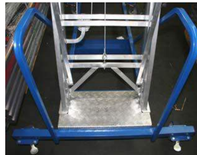
Corrimões com degrau de acesso
