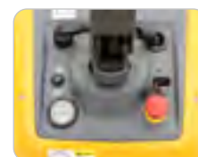
Pantalla multifunción Cuenta-horas con indicador de batería, botón de velocidad, pulsador de emergencia y la llave de contacto.
