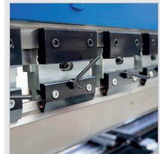
▶ Fixação manual rápida das ferramentas
