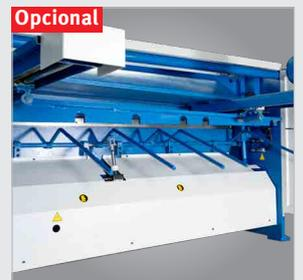
Sistema pneumático de fixação de chapas finas
