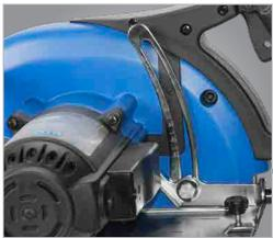
▶ Ajuste descomplicado da profundidade de corte preciso graças a uma escala de fácil leitura
