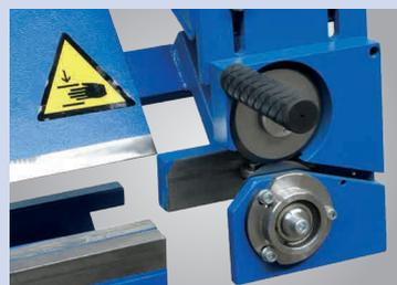
\*Dados relativos a material com uma resistência à tracção de 400 N/mm<sup>2</sup>; Espessura para Inox: fator 0,75; Espessura para alumínio: fator 1,2.
