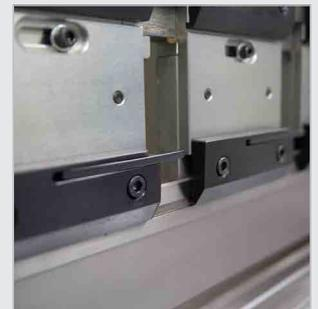
▶ Fixação rápida manual da ferramenta superior
