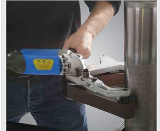
Indicado para o polimento e acabamento de tubos de construção
