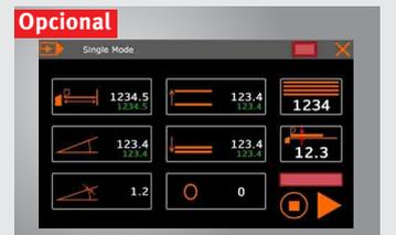
► **Controlo opcional Schneider NC2**, controlo de três eixos para entrada digital de ângulo, entrada da posição do batente traseiro e posição da abertura do segmento superior, possível armazenamento de seqüências de dobra, batente traseiro motorizado, curso de 15-1000mm
