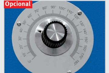
► **Controlador opcional PT 1** - Ajuste manual do ângulo através de um potenciômetro que se encontra na frente da máquina.
