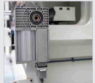
▶ "Crowning" motorizado, controlado por CNC
