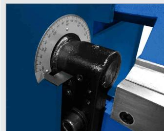
▶ Ajuste fácil e manual do ângulo de flexão graças ao limitador com escala
