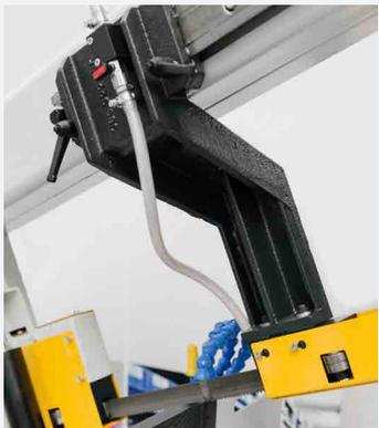
Mesa rotativa com fita de serra de 34 mm (largura) standard com guia de fita vertical
