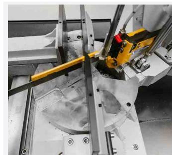
**Mesa rotativa com rolamento de esferas e placas de desgaste adicionais na fenda e grade de 15°**
