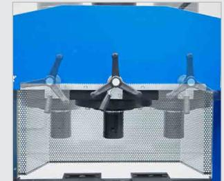
▶ Ajuste rápido do cilindro através de volante e cremalheira
