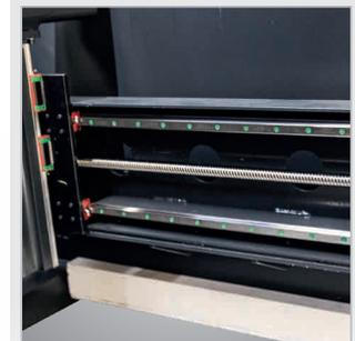
▶ Eixo X guiado linearmente através de parafuso de esferas via servomotor
