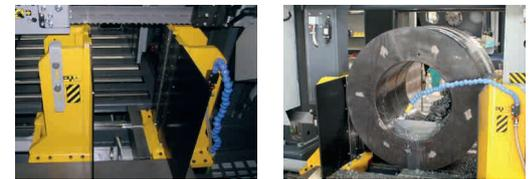
► Fixação de material na frente e atrás da linha de corte com prensa de duas partes
