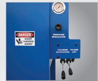
▶ Alavanca manual sensível à pressão e medidor de pressão
