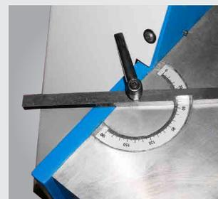
Batente lateral angular ajustável com escala milimétrica
