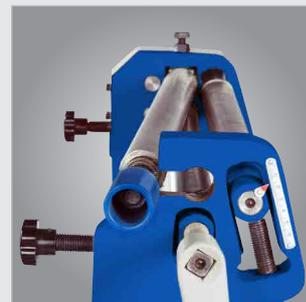
▶ O rolo superior pode ser girado para facilitar a remoção da peça acabada
