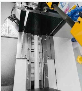
**Mesa rotativa com fita de serra de 34 mm (largura) com placas de desgaste substituíveis**
