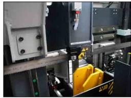
► Guia linear de 2 colunas com cilindro hidráulico
