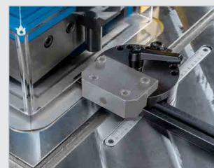
▶ Batente com dispositivos deslizantes de retenção
