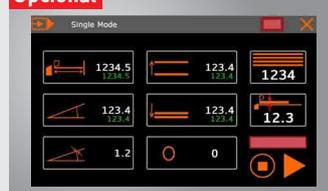
► **Controlo opcional Schneider NC2**, controlo de três eixos para entrada digital de ângulo, entrada da posição do batente traseiro e posição da abertura do segmento superior, possível armazenamento de seqüências de dobra, batente traseiro motorizado, curso de 15-1000mm
