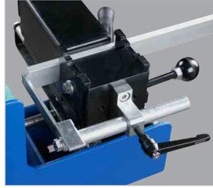
▶ Limite de comprimento ajustável sem ferramentas (apenas a 90°)
