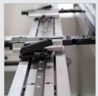
▶ Batente traseiro X / R com eixos Z manuais
