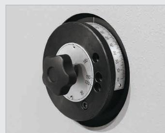
► **Controlador standard MA** - Ajuste manual do ângulo utilizando a escala no anel que se encontra na lateral da máquina.
