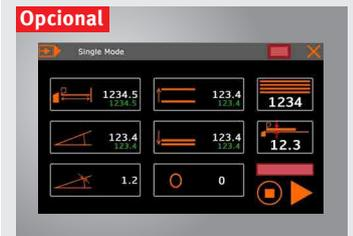
► **Controlo opcional Schneider NC2**, controlo de três eixos para entrada digital de ângulo, entrada da posição do batente traseiro e posição da abertura do segmento superior, possível armazenamento de sequências de dobra, batente traseiro motorizado, curso de 15-1000mm
