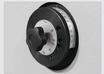
► **Controlador standard MA** - Ajuste manual do ângulo utilizando a escala no anel que se encontra na lateral da máquina.
