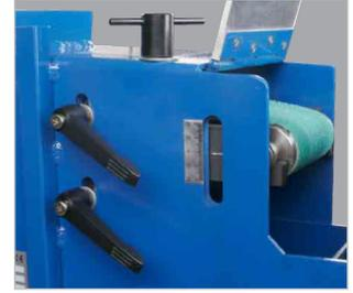
▶ Ajuste de altura da cinta de lixa simples e sem ferramentas
