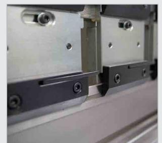
▶ Fixação rápida manual da ferramenta superior
