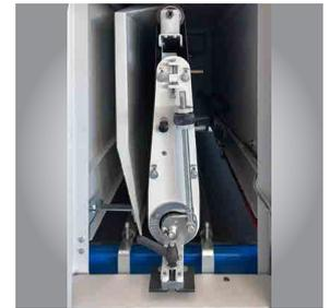
▶ Uma unidade de cinta de lixa para acabamento de superfície e lixamento longitudinal
