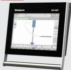
O conveniente controlo CNC DA 58T permite ao usuário programar produtos graficamente através de uma interface de toque. Ao mesmo tempo, o perfil é exibido em um gráfico 2D. As funções estão disponíveis diretamente onde são necessárias. Após criar a secção, a sequência de quinagem é calculada automaticamente e pode ser modificada pelo operador. A sequência de dobra é simulada por um gráfico 2D.
