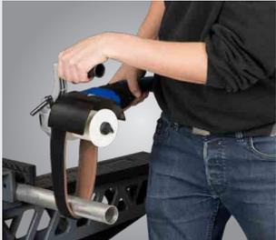
Acabamento em aço redondo com bandas de velcro para por ex. corrimões pré instalados
