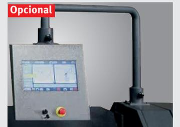
► **Controlo CNC opcional com gráficos 3D**, os perfis são feitos pelo operador num generoso ecrã touch de 19"; Todas as posições dos eixos e a seqüência de flexão são calculadas pelo controlo, batente traseiro motorizado com paragem de dedos, percurso 15-1 000 mm
