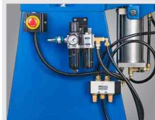
▶ Unidade de manutenção para sistema pneumático
