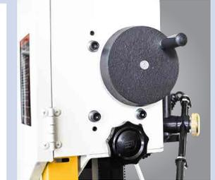
▶ Ajuste de altura do guia da fita através de volante
