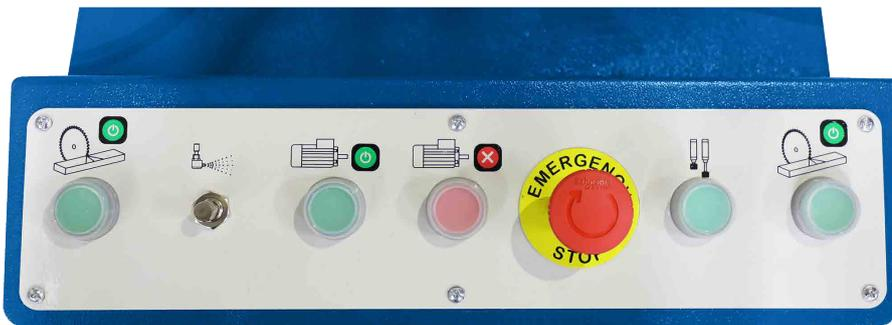
Elementos de operação da esquerda para a direita: interruptor de disco esquerdo, lubrificação, motor LIGADO, motor DESLIGADO, PARAGEM DE EMERGÊNCIA, tensionamento, interruptor de disco direito
