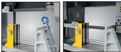
▶ Guia de fita frontal move-se em paralelo com a mordente móvel - assegurando uma guia de fita mais precisa
