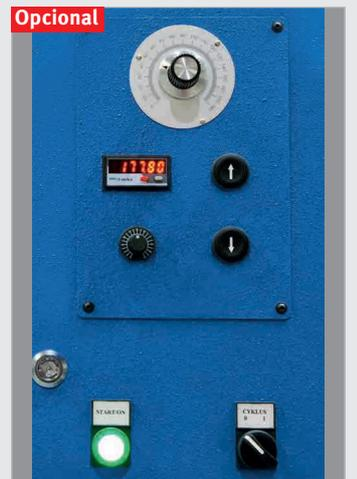
► **Controlo PUD opcional** com visor digital, ajuste manual do ângulo de curvatura e batente traseiro motorizado
