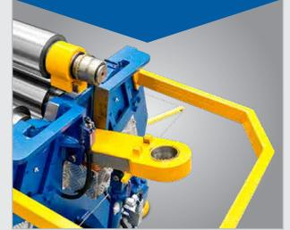
Bucha de segurança hidráulica para fácil remoção de peças acabadas
