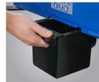
▶ Ambas as caixas de coleta de limalhas podem ser facilmente removidas
