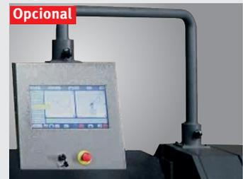
► **Controlo CNC opcional com gráficos 3D**, os perfis são feitos pelo operador num generoso ecrã touch de 19"; Todas as posições dos eixos e a seqüência de flexão são calculadas pelo controlo, batente traseiro motorizado com paragem de dedos, percurso 15-1 000 mm
