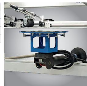
▶ Fixação da peça de trabalho através de dispositivo de fixação a vácuo
