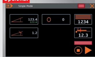
► **Controlo opcional Schneider NC1**, ângulo de dobra, batente traseiro e abertura do segmento superior via touchscreen, batente traseiro motorizado, 15-1000 mm, possível armazenamento de seqüências de dobra
