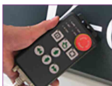
Controlo remoto para verificações e ajustes
