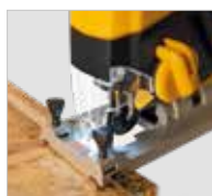
LED de iluminação da superfície de trabalho
