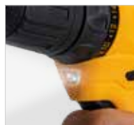
LED de iluminação da superfície de trabalho
