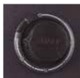
Botão seletor do nível de escurecimento
