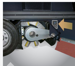
Escovas substituíveis sem necessidade de ferramentas. Pressão e ajuste de altura do rolo principal são ajustáveis separadamente
