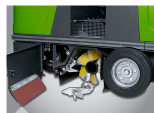
Escovas substituíveis sem necessidade de ferramentas
