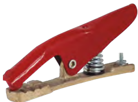
Código: WT53816 PINZA DE TIERRA 250 A FUNDICIÓN DE BRONCE
