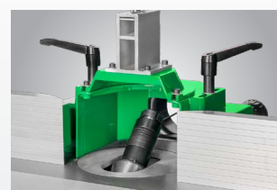
Fuso fresador retrai para uso de dispositivo de alimentação, segurança máxima e qualidade de fresagem
