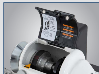
• Rolamento de fuso triplo com dispositivo de divisão e volante robusto
