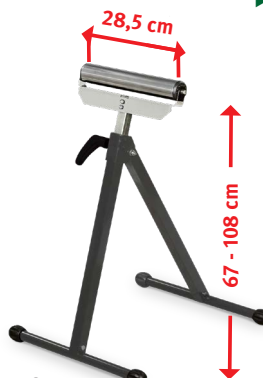
MS 3 R Cabeça de rolo com alavanca para ajuste rápido. Capacidade: > Posição interior: - 90 kg > Posição média: - 60 kg > Posição alta: - 45 kg
