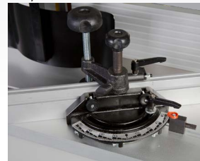
Batente de ângulo continuamente ajustável
