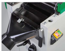
Bocal de extração integrado assegura uma visão livre durante operação
