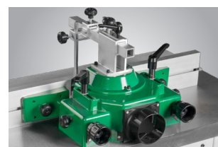
Batente de fresadora em alumínio ajustável
