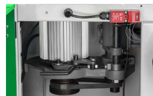
Mudança rápida e fácil de velocidades com múltiplas correias em V
