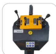
Panel de control integrado que incluye la gestión de la dirección, la activación de la vibración y el control del acelerador.
