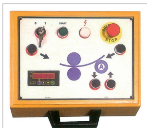
▶ Consola de controlo com display digital, alimentador de rolo lateral motorizado e botão para alimentação de material em vez de pedal (opcional)
