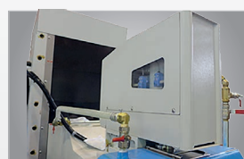
Extrator paralelo controlado por NC e dispositivo de compensação no cabeçote
