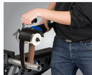
▶ Acabamento em aço redondo com bandas de velcro para por ex. corrimões pré instalados
