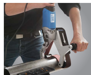
▶ O punho pode ser montado em 3 posições diferentes para melhor se adaptar ao trabalho
