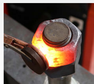
▶ Aquecimento antes de soldar
