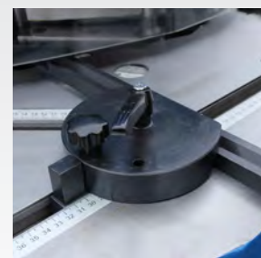
▶ Ajuste preciso do ângulo através de batentes e escalas
