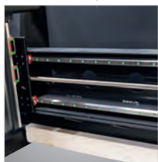
► Eixo X guiado linearmente através de parafuso de esferas via servomotor
