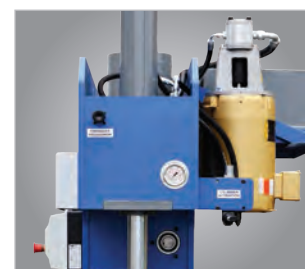
▶ Prensa de brochagem lateral com manômetro
