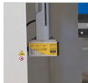
▶ Dispositivo de segurança Fiessler AKAS II
