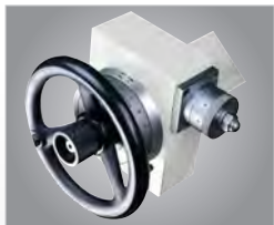
Ajuste fino para avanço vertical/transversal
