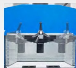
▶ Ajuste rápido do cilindro através de volante
