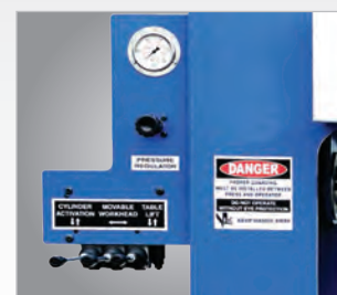
▶ Alavanca manual sensível à pressão e manômetro
