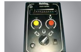
Desmagnetizador automático para base eletromagnética
