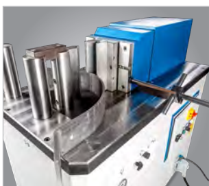
▶ Montagem de abertura rápida e travão lateral com escala
