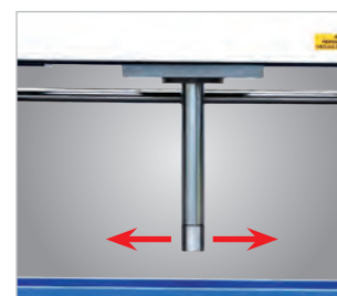
▶ Cilindro hidráulico deslocável lateralmente
