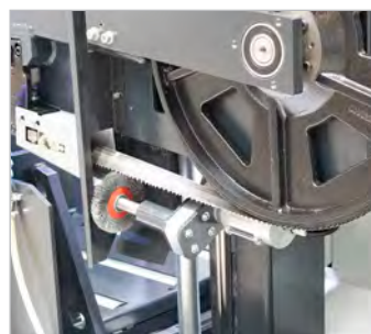
Escova de remoção de limalhas acionada eletricamente
