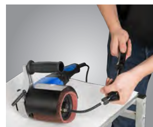
▶ Fixação fácil da manga de lixa, simplesmente bombeando ar para o rolo insuflável.
