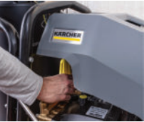
Regulación de caudal en la bomba
