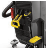
Presión del cabezal de cepillos ajustable
