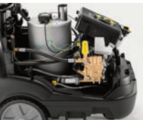
Amortiguación de vibraciones (SDS)
