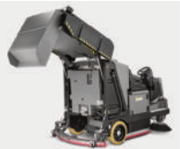
Vaciado en alto hidráulico
