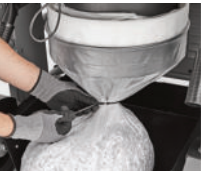
Sistema de descarga en bolsa Longopac
