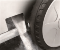
Sistema de vaciado de pellets
